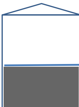
Figuur 3 — Vastdaktank met een inwendig drijvend dak
